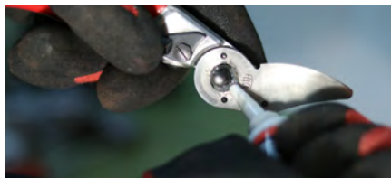
14. Mettre en place le boulon et remplir la poche de graisse.
