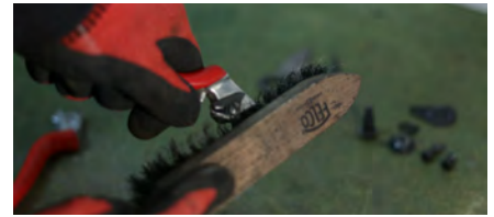
6. Brosser toutes les surfaces métalliques.
