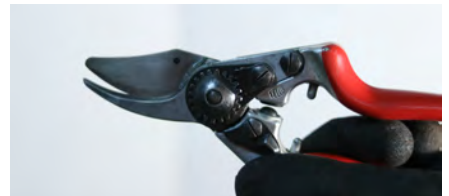
6. Le croisement doit être compris entre 1/2 et 2/3.
