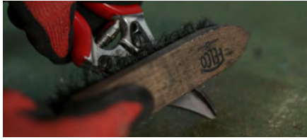
1. Utiliser une brosse métallique pour dégraisser la tête de coupe.
