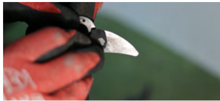
8. Utiliser la clé de réglage pour gratter les surfaces de la lame et de la contre-lame.
