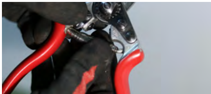
7. Remettre le ressort en place.
