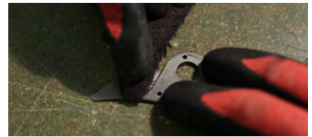
9. Finir le nettoyage de la lame et de la contre-lame avec une éponge abrasive.
