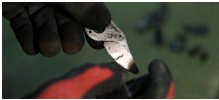
7. Nettoyer la lame et la contre-lame.
